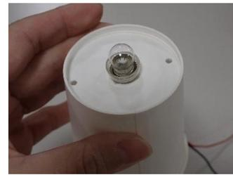
② 豆電球の赤い導線を底から小さなあなに通り、赤い導線は、右の写真のようにコップの外側にだしておく。
