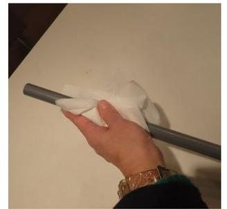
⑤ ②のコップから出ている細長いアルミニウムはくに静電気を起こさせた塩ビパイプ（またはストロー）を右の写真のように近づける。それを20回くらい、くり返すとコップに静電気がたまる。
